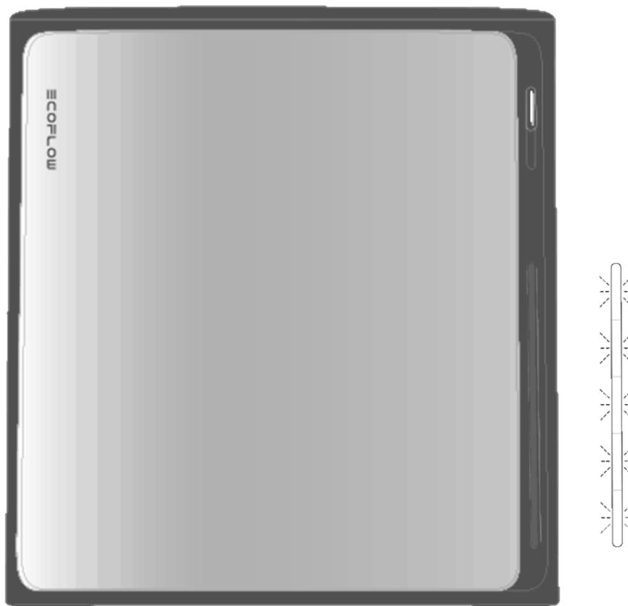
Das folgende LED-Muster zeigt an, dass eine Einstellung angewendet wurde, z. B. ein Zurücksetzen des Systems oder der Abschluss der Interneteinrichtung.
