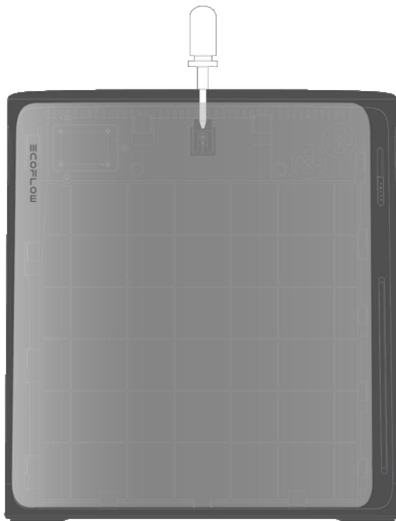
4. Stellen Sie die Position des Geräts so ein, dass die vordere Abdeckungsseite nach oben zeigt. Schieben Sie das neue Frontgehäuse von der Seite nahe dem IoT-Modul aus in die Nute und richten Sie es auf die 4 Nuten aus, um es zu befestigen. Die Montage des neuen Frontgehäuses ist dann abgeschlossen.
